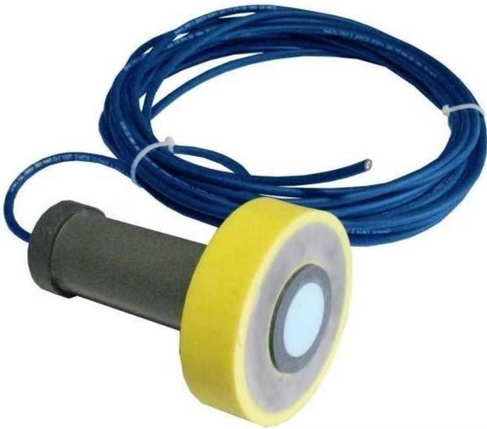
L'électrode permanente « Long Life » Cu/CuSO<sub>4</sub> se compose d'un câble HO7RNF 2.5mm<sup>2</sup> bleu relié à une barre de cuivre pure à 99,9% baignant dans un composé à base de sulfate de cuivre (CuSO<sub>4</sub>) ayant une grande capacité d'hydratation.
