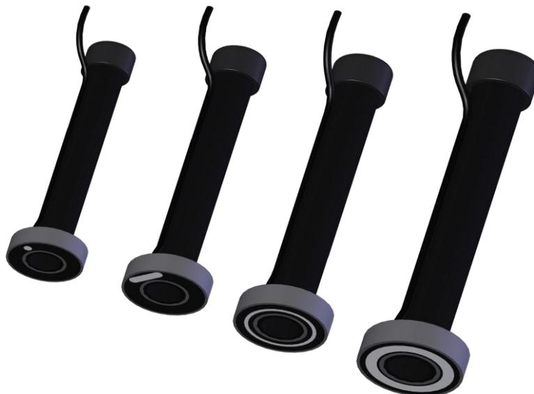
Les témoins associés à un puits de mesure sont destinés à être placés près des canalisations. Ils sont associés à un puits DN 50 pour pouvoir y glisser une électrode. Ils sont livrés en standard avec 5 mètres de câble H07RNF 2.5mm<sup>2</sup> jaune.
