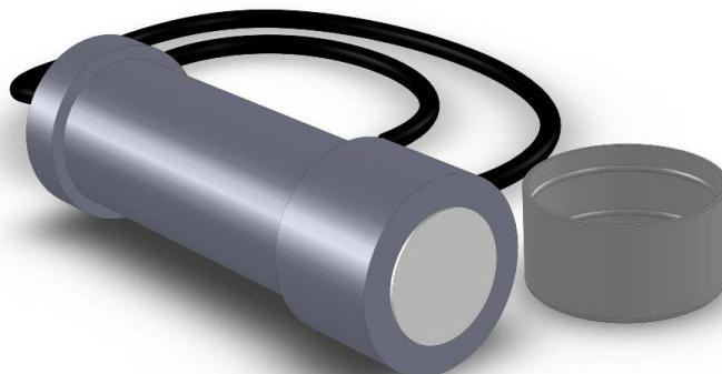
L'électrode permanente Cu/CuSO<sub>4</sub> se compose d'un câble double isolation relié à une barre de cuivre pure à 99,9%. Celle-ci baigne dans un composé à base de sulfate de cuivre (CuSO<sub>4</sub>) ayant une grande capacité d'hydratation
