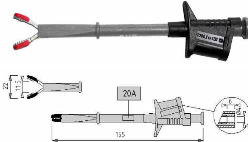
Ce grippe-test, rigide (20 A) s'adapte sur tous les cordons de sécurité  $\varnothing$  4 mm IEC.
