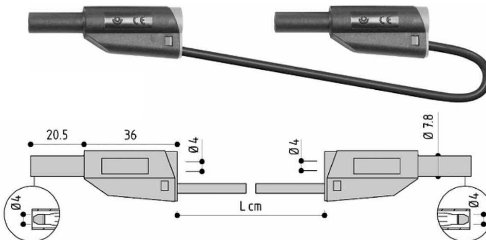
mâle-mâle  $\varnothing$  4, reprise arrière  $\varnothing$  4, sécurité fixe
